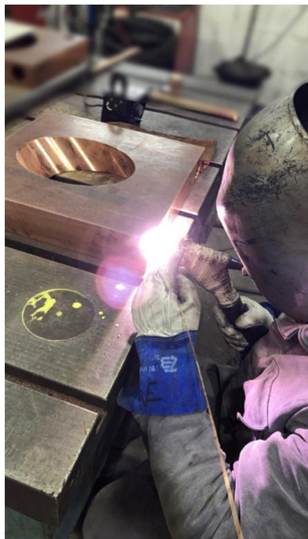
**Bild 2. Schweißarbeiten an einem Kupferbauteil** (Foto: stahlotec)
