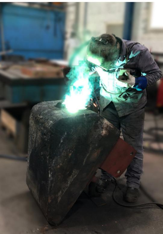
**Bild 1. Reparaturschweißarbeiten an einem Brennerkasten** (Foto: stahlotec)
